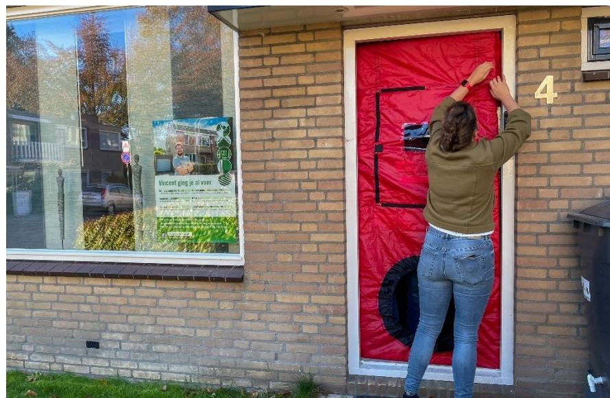
Afbeelding 7. Blowerdoortest (ook wel: kieren jagen) in een woning om kieren inzichtelijk te maken
